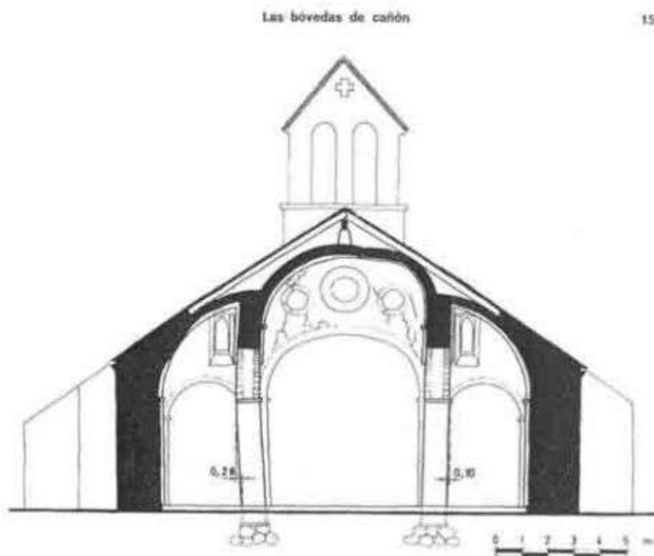
Fig. 11. Sección real del templo, en que se muestran las grandes deformaciones. Es realmente espectacular el descenso de la cumbre de la bóveda, por cuyo intradós discurre una gran grieta, así como el desplome de las columnas, que han motivado una auténtica trastiada de los cuatro arcos que hay a cada lado de la nave principal separándola de las laterales.
